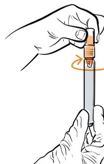
4. Das Ventil einsetzen und die Stiftkappe wieder auf den Stiftkörper aufschrauben.
